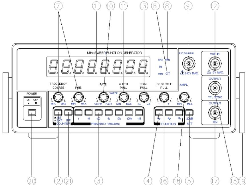
FIG 1-2. FRONT PANEL OPERATOR'S CONTROLS(FG-7005C,)
