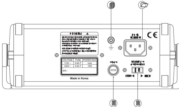
FIG 2-1. REAR PANEL(FG-7002C)
